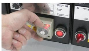
Встроенный таймер обратного отсчета предназначен для отслеживания времени прогрева заготовки и упрощает работу при серийном производстве одинаковых изделий. Струны таймер не включает и не выключает.
