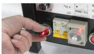
Силовой блок станка имеет свой поворотный выключатель питания станка с подсветкой.
