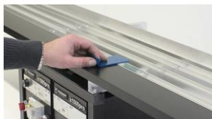
Министол предназначен для работы с мелкими заготовками, когда размещение их на профилях струн затруднено.
