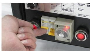
Каждая струна имеет свой выключатель. Включать/выключать струны можно в любом порядке.
