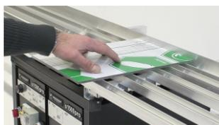
Упор задний позволяет делать калиброванный отступ от края детали до ближайшегогиба, что очень удобно при серийной гибке одинаковых изделий.
