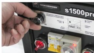
Регулятор мощности, общий для всех струн, позволяет корректировать температуру в зоне прогрева материала от 100 до 300°C.
