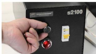
Регулятор мощности позволяет корректировать температуру в зоне прогрева материала от 100 до 300°C.
