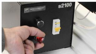
Силовой блок станка имеет поворотный выключатель питания станка с подсветкой.
